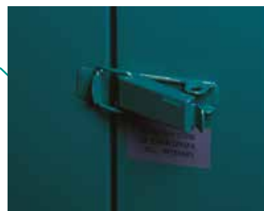
Chiusure a scatto lucchettabili. Lamiera zincata di tipo automobilistico e verniciatura con speciali polveri epoxipoliesteri per uso in esterni. Colore standard verde RAL 6016
